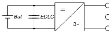
Figura 2.16 - Configuração passiva paralela [19].
